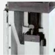
As prensas LP e LHP da GECHTER a partir de 4 kN são equipadas de série com um ajuste preciso do pistão. (graduação 0,05 mm)
