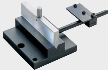
Herramientas de doblado prismático de 90° o 60° con tope longitudinal ajustable hasta 130 mm y 120 mm de anchura
